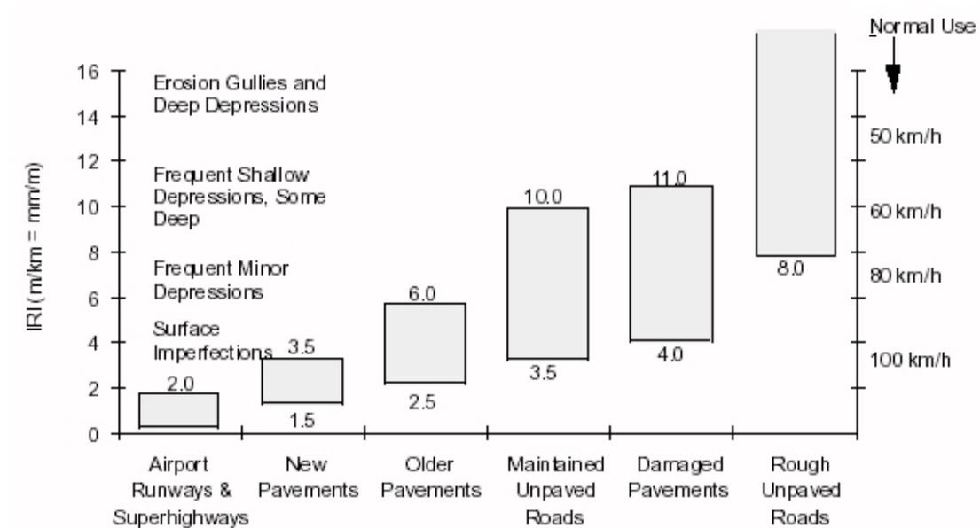
Figure 16: IRI Roughness Scale<sup>15</sup>
